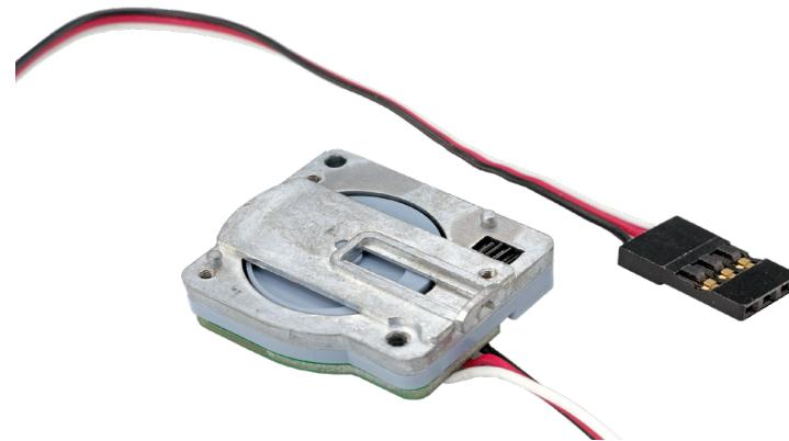
Dieses Linearservo in den Dimensionen 26mm x 22,5mm x 10,8mm ist hauptsächlich für den Einbau in E-Loks gedacht, um dort Stromabnehmer nachträglich heb- und senkbar zu machen. Die Mechanik ermöglicht einen sehr leisen, ruhigen Lauf und vermeidet die Geräuschentwicklung handelsüblicher Servos. Der Servoweg beträgt ca. 4,5mm.
