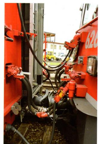
— Kupplungsbild eines NEVA-Retica-Pendelzuges mit einer Ge 4/4 III – hier erkennt man das Übergangskabel der alten Kheops-Dose an der Lok zur 61-poligen Vielfachsteckdose des Wagens. Ansonsten sind die 18-polige LBT, Heizkupplung und je zwei Vacuum- bzw. Hochdruck-Schläuche verbunden.
