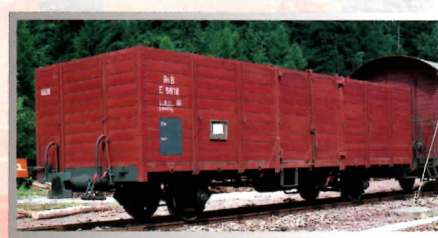
Hochbordwagen Neuauflage der Hochbordwagen E 6601-6670 (ex L3) mit Achsstand 4,7 m im Zustand der 70er/80er-Jahre mit Holzbeplankung. E 6611 Hochbordwagen 2251 111 E 6618 Hochbordwagen 2251 118
