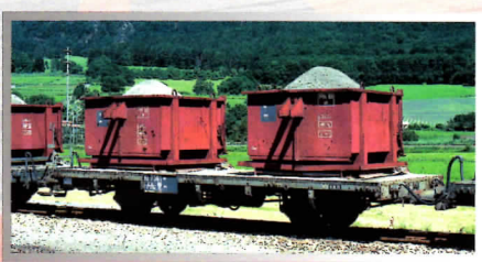
Kieswagen 1963-64 baute man einige Niederbordwagen der Serie M1 7301-7385 aus dem Jahren 1911-13 zu provisorischen Kieswagen mit je zwei abnehmbaren Behältern um. Wiederauflage dieses Wagentyps mit neuen Betriebsnummern. Kk 7352 Kieswagen 2258 112 Kk 7360 Kieswagen 2258 110
